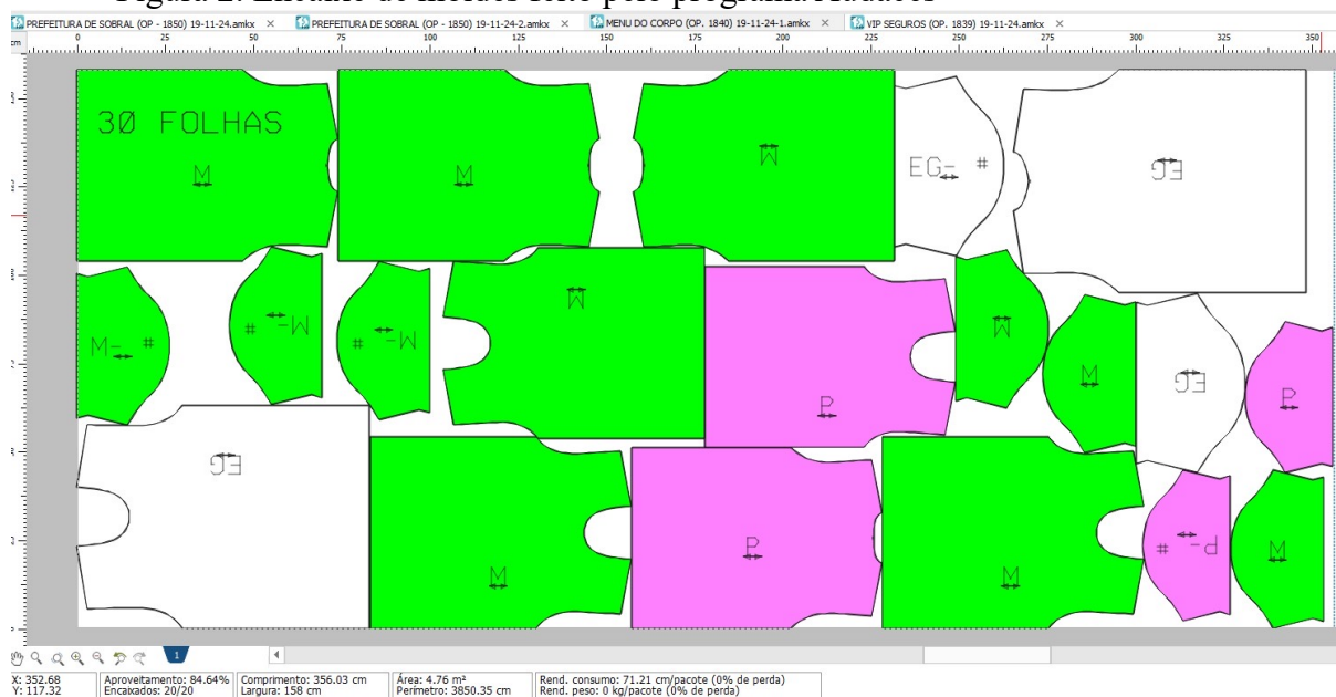
Figura 2. Encaixe de moldes feito pelo programa Audaces
