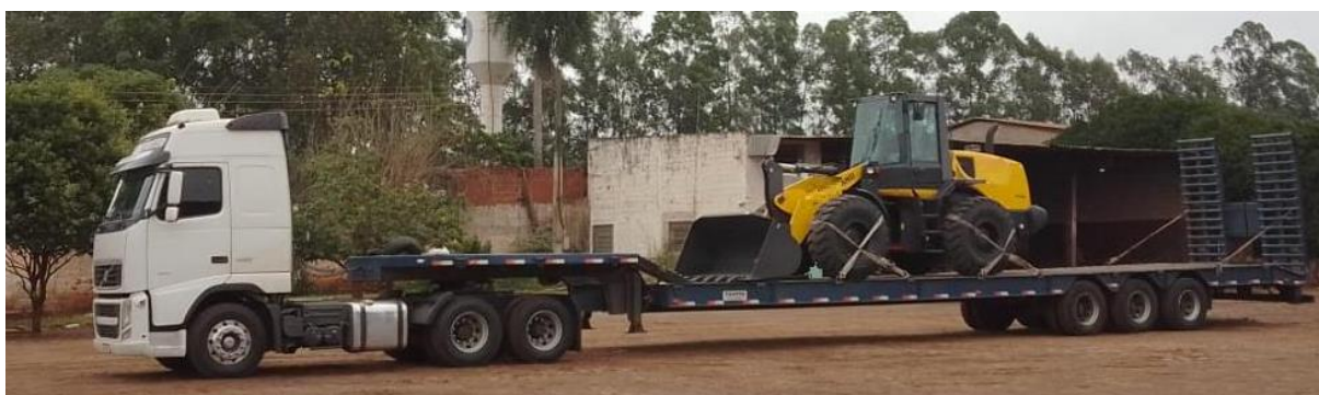
Figura 3 – Veículo FH 460 acoplado a uma prancha carregado com um equipamento
