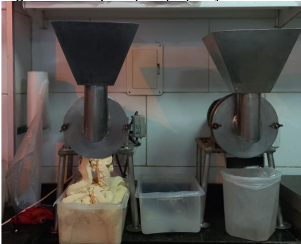
Figura 2 – Máquina para preparação da massa do acarajé e abará
