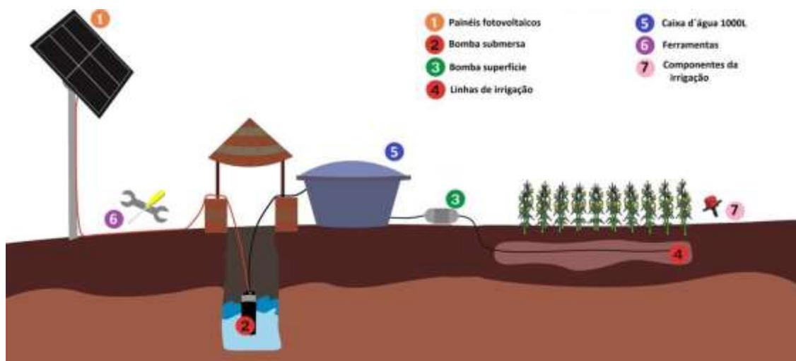
Figura 2 - Sistema automático de irrigação
