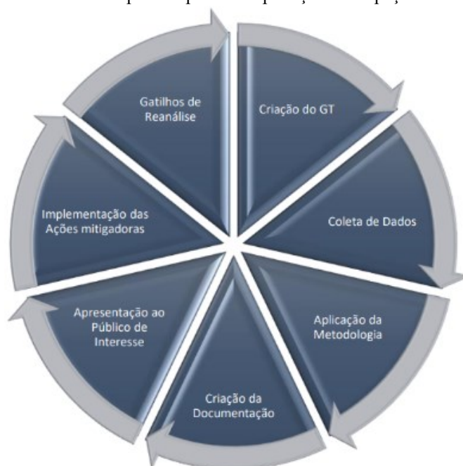
Figura 2 – Fluxo do passo a passo de aplicação da inspeção baseada em risco.
