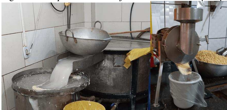
Figura 3 – Máquina de lavar feijão e moinho elétrico para preparo de massa pronta
