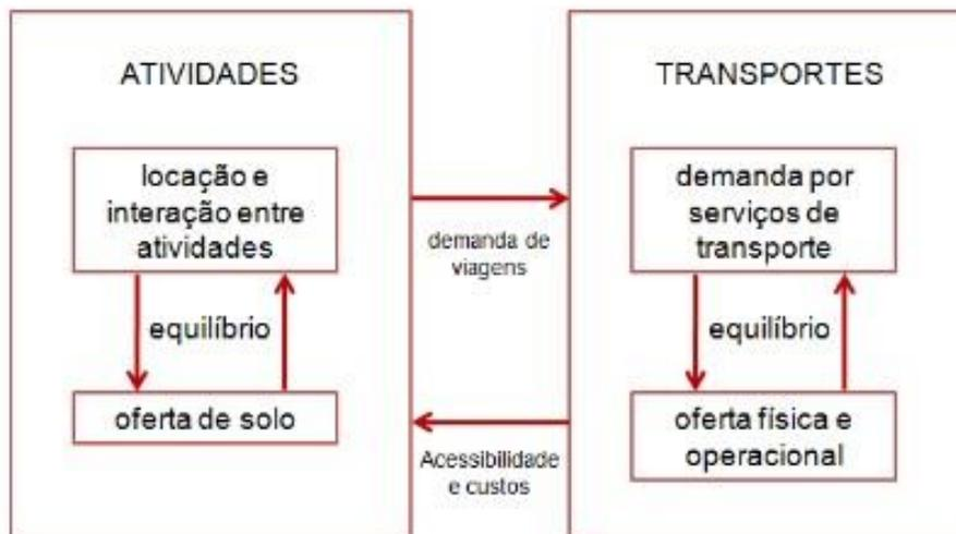
**FIGURA 4** – Demonstração do funcionamento do planejamento de um sistema conjugado que inclua, ao mesmo tempo, oferta de solo com diferentes usos e oferta física e operacional das vias públicas.
