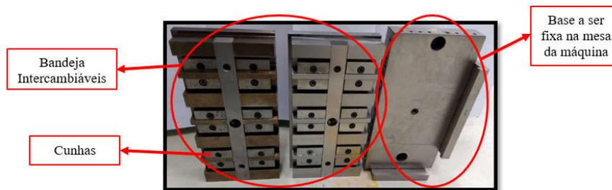
Figura 1 - Dispositivo de setup rápido.
